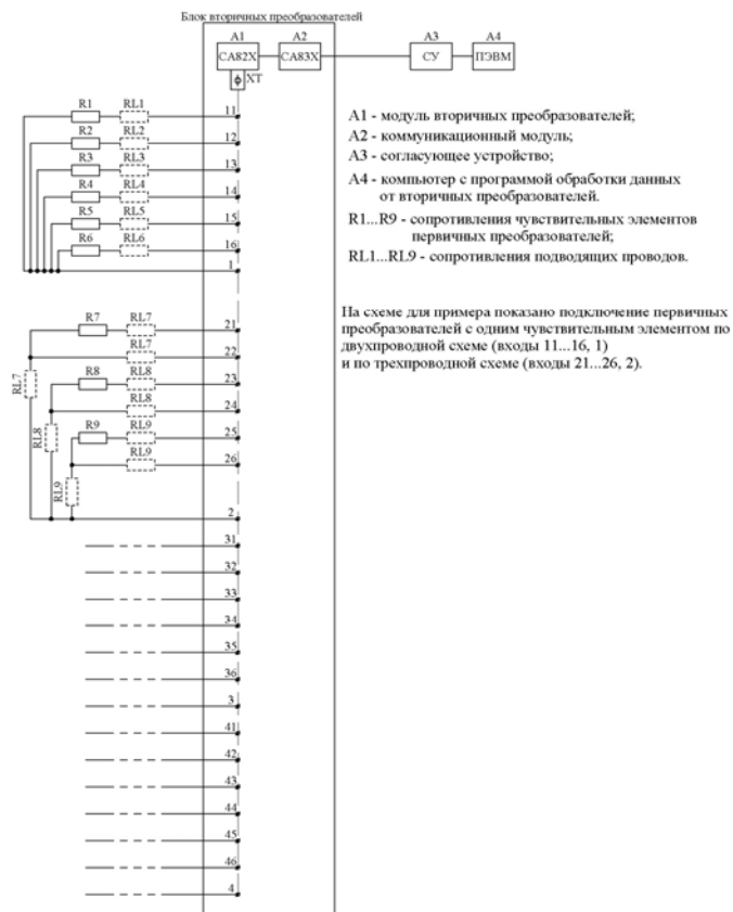
Схема подключения первичных преобразователей с одним чувствительным элементом
