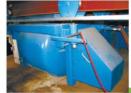
АТК АДБ отличаются большим количеством вариантов компоновочных решений, что позволяет адаптировать их к различным схемам транспортирования бетонных смесей на заводах. АТК АДБ можно применять, в том числе, и взамен имеющихся, устаревших систем доставки, оснащенных бетоновозными тележками СМЖ.
