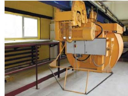
Скорость и режим опрокидывания транспортирующих емкостей кубелей настраивается в зависимости от подвижности бетонной смеси и условий выгрузки также посредством использования привода с векторным частотным управлением.
